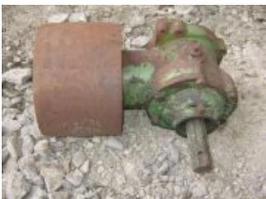
[Riemenscheibe mit Winkelgetriebe und Zapfwellendurchtrieb](#)
